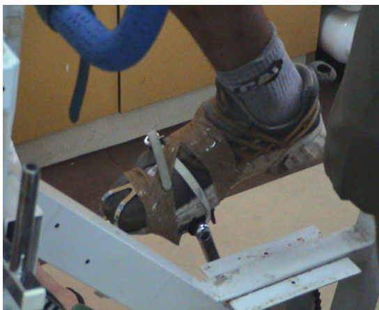
Εικόνα 8.4 Α και Β Θέση του δοκιμαζομένου και σταθεροποίηση των ποδιών στα πετάλια με αυτοκόλλητη ταινία και της λεκάνης στη σέλα με ειδικούς ιμάντες.
