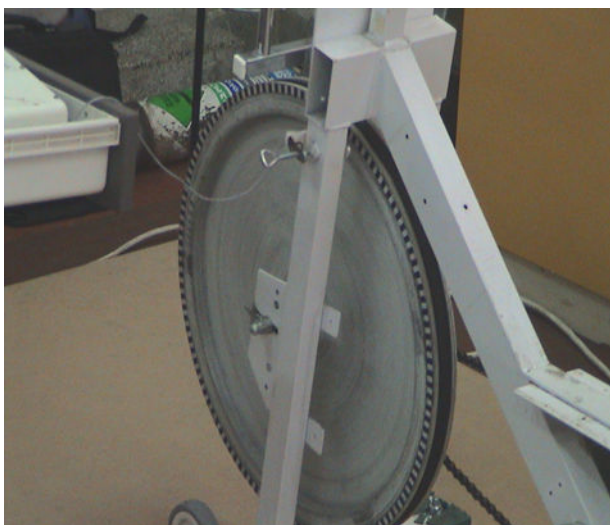
Εικόνα 8.1 Καταγραφή δειγματοληψίας της ταχύτητας περιστροφής του τροχού με υψηλή συχνότητα δειγματοληψίας μέσω χρήσης ειδικού φωτοκυττάρου.
